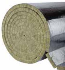
Le matelas à lamelles en laine minérale MW ou laine de roche, recouvert d'un côté d'un revêtement en aluminium, est conçu pour l'isolation thermique et acoustique des conduites de ventilation et de climatisation, des chaudières à basse température, des petits réservoirs et des surfaces cylindriques.
