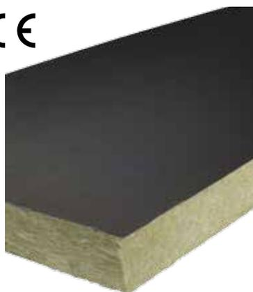
Panneaux en laine minérale ou laine de roche semi-rigide pour l'isolation thermique et acoustique de conduits d'air et autres installations de ventilation. Le matériau a sa face frontale revêtue d'un tissu de verre noir et sa face dorsale, d'un matelas en fibre de verre gris. Egalement disponible avec des densités de 40kg/m<sup>3</sup> & 80 kg/m<sup>3</sup>.
