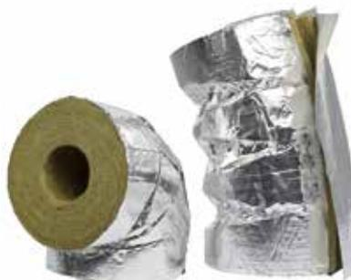
Coudes isolants de laine minérale ou laine de roche, recouvertes d'un revêtement aluminium renforcé (AluCoat, GreyCoat ou BlackCoat) avec bande auto-adhésive intégrale. La solution permet un raccord précis à des coudes à 90 degrés de rayon 1,5D, ce qui améliore de façon significative l'efficacité des travaux d'isolation.
