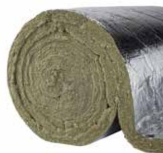
Le matelas en laine minérale MW ou laine de roche flexible, recouvert d'un côté d'un revêtement en aluminium, est conçu pour l'isolation thermique et acoustique des conduites de ventilation et de climatisation, des chaudières à basse température, des petits réservoirs et des surfaces cylindriques.
