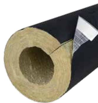
Coquilles conçues pour l'isolation thermique et acoustique de tuyaux de chauffage, de tuyaux de chauffage central, de conduites de climatisation, et de certains conduits de cheminée. Le produit est recouvert d'une couche de peinture noire supplémentaire, qui 'cache' efficacement l'installation dans des vides aériens, comme au-dessus des restaurants et des théâtres, évitant la nécessité de dissimuler les services à l'aide d'un plafond suspendu.
